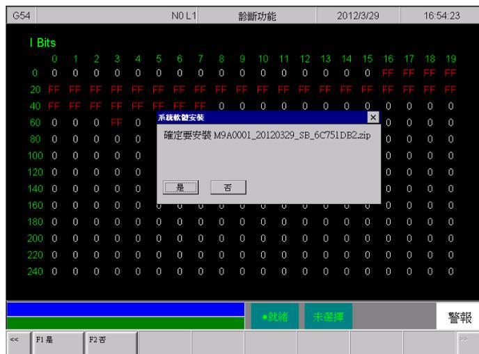
等待備份完成後，會顯示 "系統資料完成安裝，需重新啟動系統"，此時按下 "F1 確定" 後開始重新啟動系統，如圖所示。
